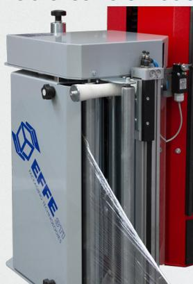
Le système de **pré-étirage à deux moteurs** peut être installé sur demande.
